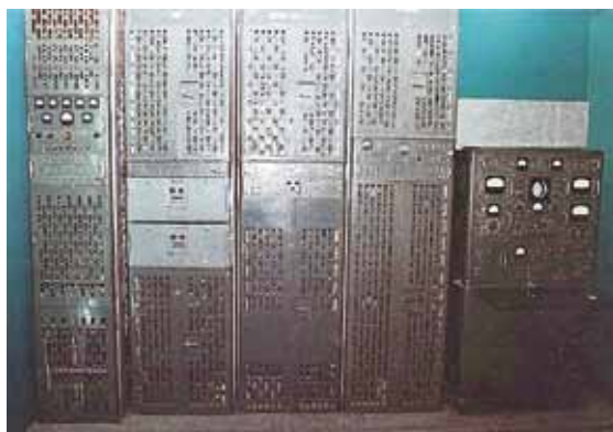
Апаратура засекречування телефонного каналу гарантованої стійкості М-803-5.
