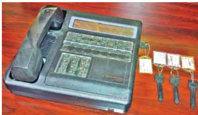
Телефон «Моторолла» з вбудованим шифратором, подарований американцями.
