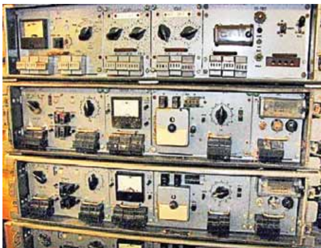
Одноканальна апаратура ущільнення П-309 «Крапля».
