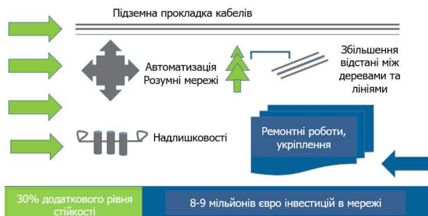
Малюнок 4.3. Заходи стійкості в електричній мережі
